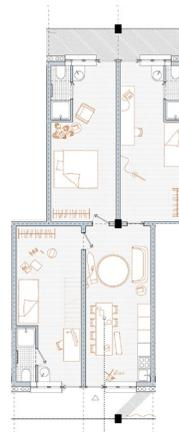
Abb. 38 Grundriss einer Wohnung mit vier Modulen | EMI Architekt\*innen AG ETH SIA BSA (Zürich)
